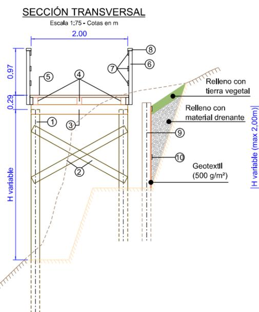
LOS ELEMENTOS EN MADERA ASERRADA SERÁN ASIMILABLES A LA CLASE RESISTENTE C18, SEGÚN C.T.E./EUROCÓDIGO 5
